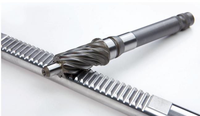
**3** Mittels Außenräumen gefertigte Zahnstange und die dazugehörige Ritzelwelle. Gemeinsam bilden sie das mechanische Lenkgetriebe eines Fahrzeugs © Il Kwang Tools
